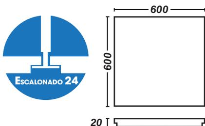
Techo desmontable de placa de escayola (aligerada con perlita y fibra de vidrio de refuerzo). Medidas 600 x 600 mm y espesor 20 mm. Para sistemas de suspensión con perfilaría de 24 mm.
